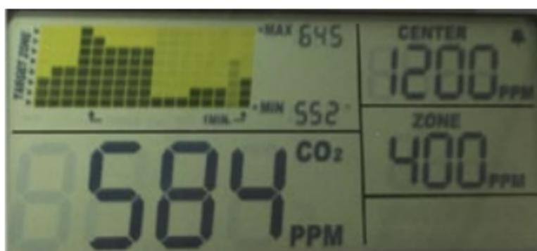
EL dispositivo muestra constantemente el CO<sub>2</sub> que hay en el ambiente, configure la el valor central y la zona.
